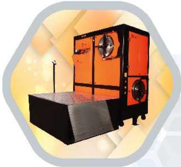
در این دستگاه اپراتور زباله را به مرور وارد دستگاه می کند و زباله ها پس از ورود بر روی خرد کن قرار می گیرند و خرد کن شروع به خرد کردن زباله ها به قطعات ریز می نماید. زباله پس از خرد شدن به روی یک سینی مدور که در حال چرخش است ریخته می شوند که از قبل در زیر این سینی گیسه مشکی رنگی نصب گردیده است و زباله های جامد وارد این گیسه ها می شوند.
